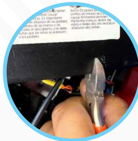
**16º** Prenda o chicote do pedal e o cabo auxiliar a partes seguras da carcaça, de forma a eliminar o risco de o cabo não se mover durante o fechamento. Se não estiver preso na carcaça, há o risco de o cabo ser esmagado por algum parafuso durante o fechamento.
