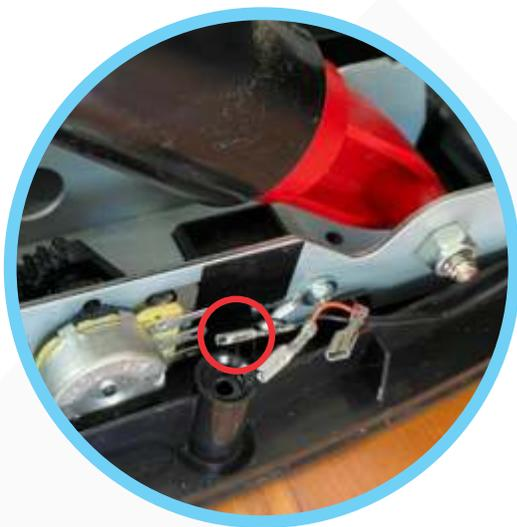
6º Remova também a conexão de aterramento (**fio preto** conectado por um parafuso ao pedal). Use uma fita isolante para isolar o terminal de aterramento.
