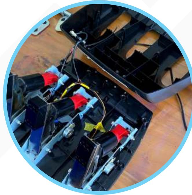
**15º** Com um estilete ou um alicate de corte, aumente a passagem do fio do pedal para suportar a passagem do cabo USB. Prenda o cabo USB junto ao cabo original do pedal, de forma que proteja o cabo USB contra acidentes (puxar o cabo de forma não intencional).
